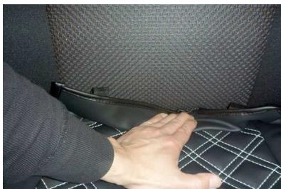
5 背もたれと座面の隙間に生地を入れ込みます。シートの角度を調整して入れ込みやすい位置で生地を入れ込んで下さい。
