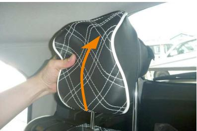
7 2列目ヘッドラストは図の矢印方向に、ヘッドラストのラインに合わせて下から上へかぶせます。カバーは平らなプラスチックが付いている方が前です。
