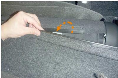
8 シートを前に倒してシート背面から純正のシート表皮を固定しているプラフックを外します。フックはU字のフックにツメのあるフックをはめて固定しています。矢印のようにフック部分をひねるようにして外します。
