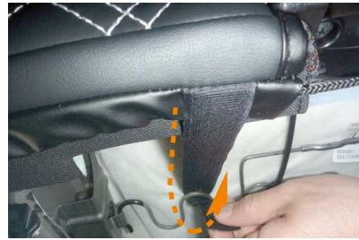
12 カバー前側のスライドレバー部の両端に付いているマジックテープを、シート裏の金属部分に巻き付けて固定します。マジックテープの固定方法はアページ16番17番を参照下さい。
