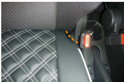
8 カバー内側の生地が、軸の部分に沿うようになっていることを確認します。ずれている場合はカバーの装着位置を調整して下さい。
