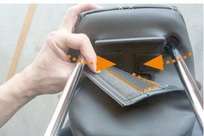
9 ヘッドラスト裏で生地を内へ寄せながらマジックテープを固定して、1列目同様にプラフックを固定します。
