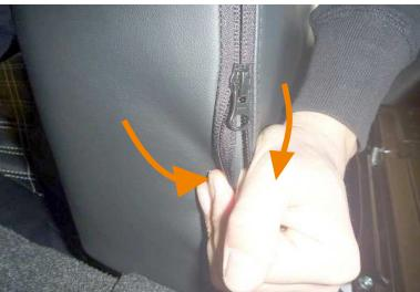
13 カバー側面のファスナーを内へ寄せながら慎重に閉じます。ファスナーの端はカバーの中へ入れ込みます。
