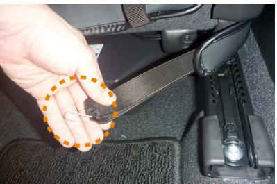
9 カバー内側面後ろ側の生地の端に、ゴムが付いています。ゴムに付属の金属フックを取り付けます。
