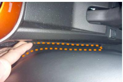
8 カバー内側面前側の生地裏に付いているマジックテープを、シートに直接貼り付けて固定します。
