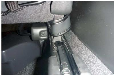
10 カバー内側面後ろ側は図のように固定されます。
