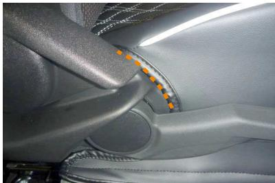
7 カバーのラインを確認します。外側面の生地がシートのプラスチック部分に沿うようになっていることを確認します。ずれている場合はカバーの装着位置を調整して下さい。
