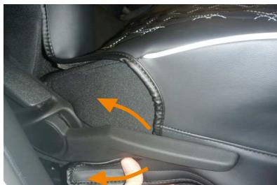
4 シート外側のシートリフターのレバーをかわしてカバーをかぶせます。
