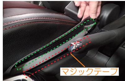
11 内側面には上下2ヶ所にマジックテープが付いています。先に上側（赤線部）のマジックテープを固定し、次に下側（緑線部）のマジックテープをシートに直接貼り付け固定します。
