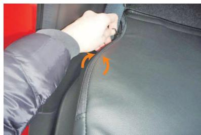
5 生地を内へ寄せながら側面のファスナーを閉じます。ファスナーの端はカバーの内側へ入れ込みます。
