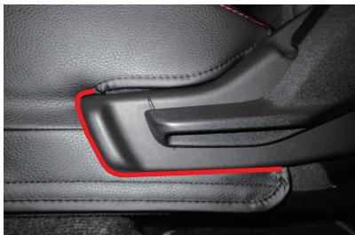
**15** プラスチック部の上側は、生地が入り込むほどの隙間が無い為、図の赤線部分の隙間に生地を入れ込みます。
