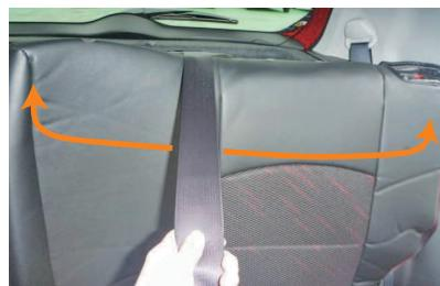
2 シートベルトをかわしながら、シートのラインに合わせて、カバーを全体にかぶせます。カバーのヘッドレスト用加工穴をヘッドレスト台座の穴位置に合わせるようにして下さい。
