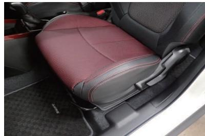
**16** 両側面以外のカバーの固定方法は、運転席座面と同様に取り付けます。
