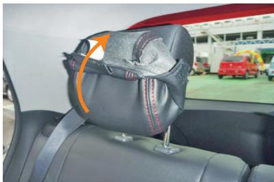
1 始めにカバーの前後を確認します。平らなプラスチックが付いている方が前側です。カバーを図のように下から上に向かってかぶせます。
