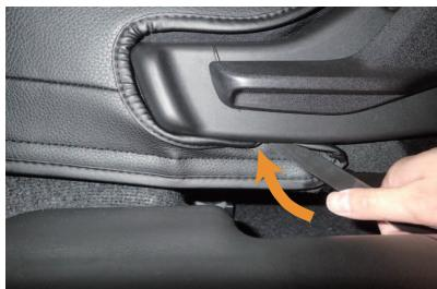
**14** 外側面の生地をマジックテープで固定し、生地の一部をヘラ等を使用し、シートのプラスチック部の隙間に入れ込みます。
