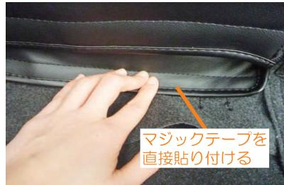
10 引き出した生地の先端にはマジックテープが付いています。このマジックテープを直接シートに貼り付けて固定します。
