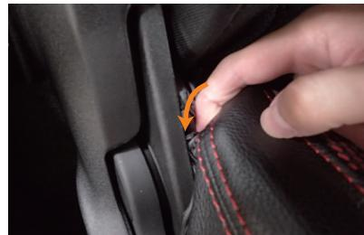
10 マジックテープを固定した後、プラスチックの隙間（8番の○部）に生地を入れ込みます。
