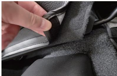
9 通した生地に付いているマジックテープをシートに直接貼り付け固定します。
