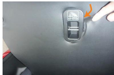
11 背面のチャイルドシート用アンカー部の隙間に生地を入れ込みます。
