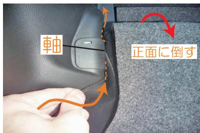
14 背もたれを正面に倒し、13番のヒモを背もたれの軸（13番のO部）をかわしながら背面へ通します。反対側のヒモも同様に通して下さい。
