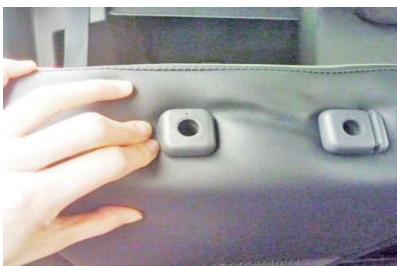
2 生地の伸びを利用して、カバーの加工穴からヘッドレストの台座を取り出します。
