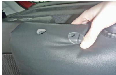
4 生地の伸びを利用して、カバーの加工穴からヘッドレストの台座を取り出します。
