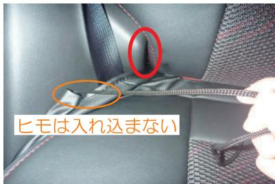
13 カバー両側面の生地をシートと車体の隙間に入れ込みます。側面の生地にはヒモが付いているので、そのヒモは入れ込まないように注意して下さい。
