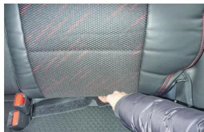
5 カバー下部の生地を背もたれと座面の隙間に入れ込みます。
