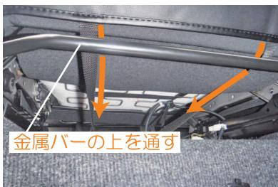
5 カバー前側に付いているベルトをシートの背面へ通します。この際、金属のバーが手前にあるのでその上にベルトを通します。運転席座面にはシートヒーターの配線があるので、ベルトが干渉しない様に気を付けて作業を行って下さい。
