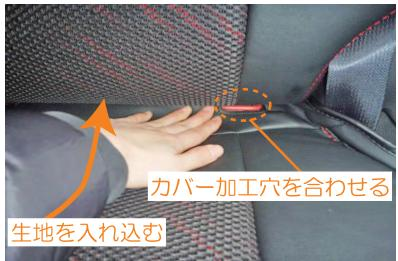
7 カバー奥の加工穴（左右2ヶ所ずつ）をチャイルドシート用アンカーに合わせ、背もたれと座面の隙間に生地を入れ込みます。
