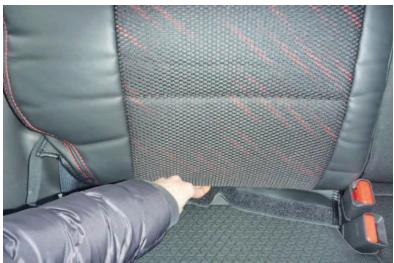
3 カバー下部の生地を背もたれと座面の隙間に入れ込みます。
