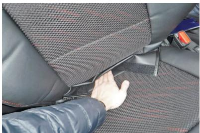
8 カバー下部の生地を背もたれと座面の隙間に
