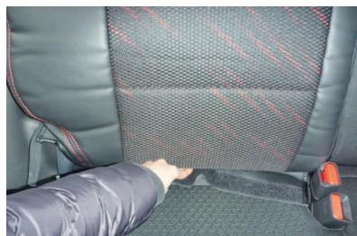
5 座面と背もたれの隙間にシート下部の生地を入れ込みます。
