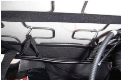
13 8P 12番で取り付けた金属フックをシート裏の金属部に引っ掛けで固定します。
