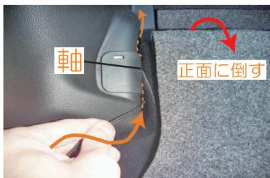
14 背もたれを正面に倒し、13番のヒモを背もたれの軸（13番の図〇位置参照）をかわしながら背面へ通します。反対側のヒモも同様に通して下さい。
