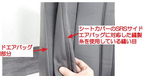
3 サイドエアバッグの展開部分と、シートカバーのSRSサイドエアバッグに対応した縫製系を使用している縫い目の位置（以降SAB対応の縫い目部分）を合わせます。
