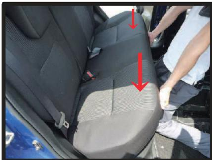
① 2列目座面はシートを車体から取り外してから、カバーの取り付けを行います。シートを図のように持ち上げると矢印部分のシート裏にあるフックが外れて、シートが取り外せます。フックを外すのにある程度の力が必要になります。作業は慎重に行ってください。
