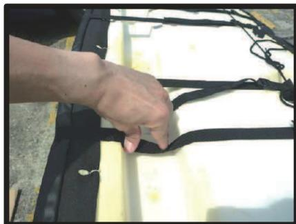
⑩ベルトは強く引いてしまうとシートが車体に戻らなくなります。図のシート裏の凹み部分にベルトを指で押し付けて、少し突っ張るぐらいにベルトは調整して下さい。
