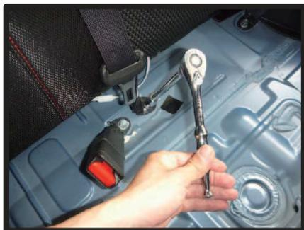
①2列目背もたれの助手席側です。中央のシートベルトをソケットレンチなどを使用して外します。
