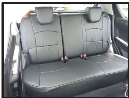
⑱カバーのラインを整えて、2列目背もたれの完成です。 運転席側は一部形状は異なりますが同様に取付けます。
