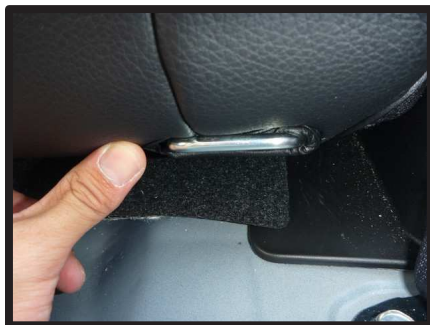
⑭シート正面下にあるチャイルドシート固定用バーを、カバーの加工穴から取り出します。
