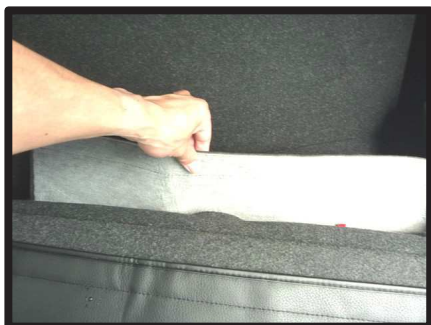
⑮入れ込んだ生地をシート背面から引き出します。 ラゲッジボードを外すと生地を容易に引き出せます。
