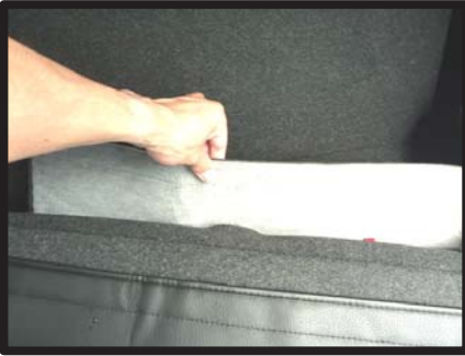
⑮入れ込んだ生地をシート背面から引き出します。 ラゲッジボードを外すと生地を容易に引き出せます。
