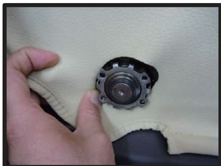
⑦カバー外側側面に開けている穴位置を、シートリフターの軸の部分に合わせます。
