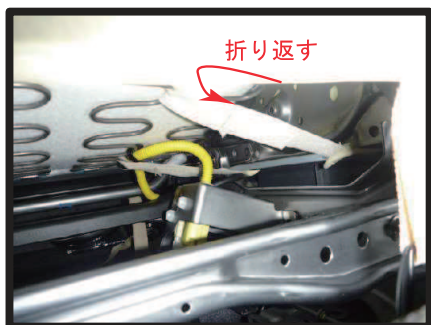
⑫マジックテープのベルトは、シート裏の金属部分に引っ掛けて折り返し固定します。
