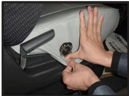
⑥側面にあるカバーの穴から、シートリフター取り付け部分を抜き出します。
