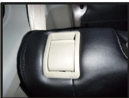
⑮カバーをレバーとシートの隙間に入れ込み、外したネジを元に戻すと図のように仕上がります。
