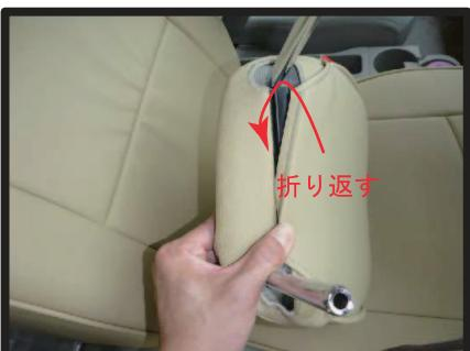
③平らなプラスチックの付いた部分を内側へ巻き込むように折り返して、カギ状のプラスチックの溝に押し込んでいきます。
