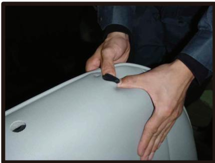
⑤ヘッドレストの台座部分を取り出します。生地の伸びを利用して横からカバーをもぐり込ませるようにして台座部分を取り出します。
