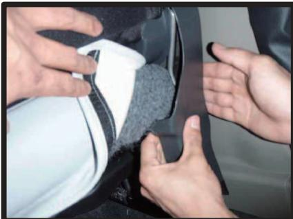
⑬窓側のマジックテープの固定は、プラスチックカバーを少し浮かせた状態でシートに取り付けます。
