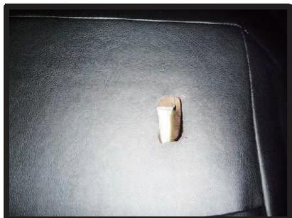
⑤付けた印部分を図のように切り抜きます。生地を切り抜く際に、シートを傷付けないようにご注意下さい。
