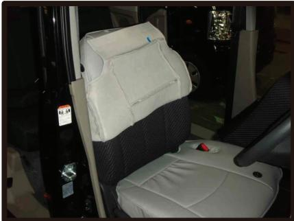
④ヘッドレストを外します。背もたれカバーを半分ほど裏返してシートにかぶせます。ヘッドレストの台座とカバーの穴位置を合わせ、肩口までしっかりとかぶせます。
