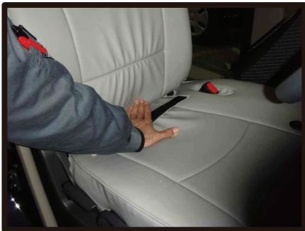
⑥折り返していた半分を左右均等に下まで引き下げ、背もたれと座面の隙間にカバーを入れ込みます。
