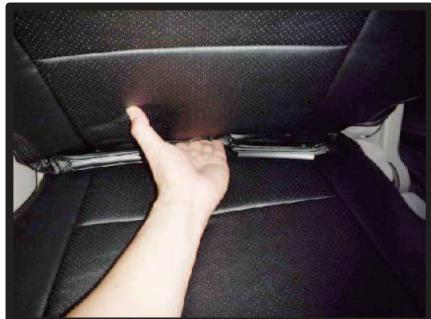
④大きなプラスチックフックが付いた部分を、背もたれと座面の隙間に入れ込みます。フックでカバーに傷を付けないようにご注意下さい。
