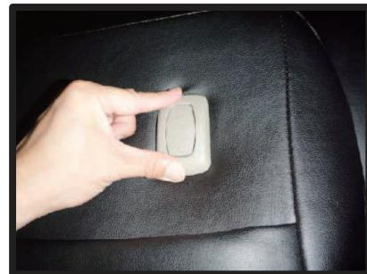
⑥穴開け加工した部分にコンビニフックを押し込み元に戻します。最後にフックを軽く引っ張り、確実に固定されているか確認して下さい。
