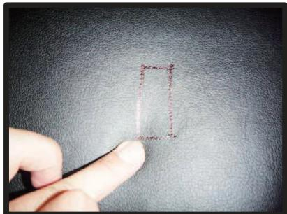
④カバーを装着後、コンビニフックの穴位置を確認して、穴のフチに沿って印を付けます。
