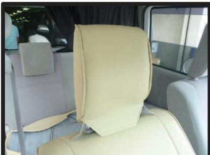
②ヘッドレスト本体を押しつぶしながらカバーに入れ込んでいきます。縫い目の部分に力がかかりすぎるとカバーが破れる恐れがありますので、作業は慎重に行って下さい。
