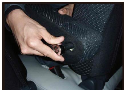
⑲ソケットレンチを使用してボルトを外します。
