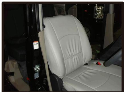
⑨サイドエアバッグ装備車は、サイドエアバッグの展開部分とシートカバーのSAB対応の縫い目部分が合っていることを確認して下さい。
