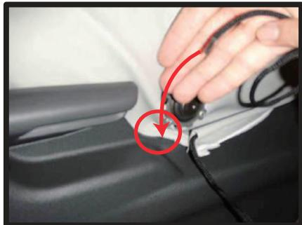
⑦カバー側面のヒモを、シートとプラスチックカバーの隙間にに入れ込みます。
