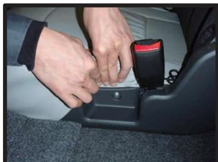
③側面部分のカバーは、プラスチックカバーとシート本体の間に、生地を入れ込みます。
