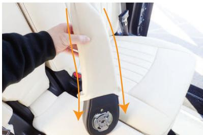
1 カバーの向きを確認します。加工穴が大きい方が、アームレストの内側になります。カバーの加工穴の大きい方にアームレストを通し、かぶせます。アームレスト先端までしっかりとかぶせて下さい。
