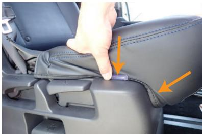
4 カバー両側面の固定部材を、生地ごとシートとプラスチックカバーの隙間に入れ込みます。固定部材が付いていない箇所の生地も隙間に入れ込んで下さい。
