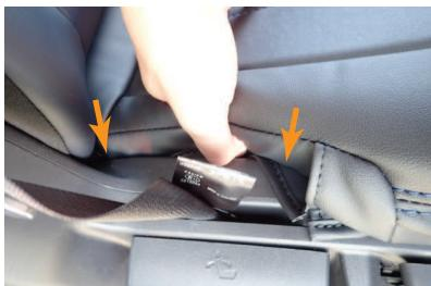
5 カバー外側面のシートベルト付近の生地をプラスチックカバーの形状に沿うようにして入れ込みます。
