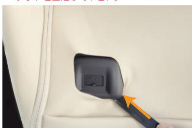
12 背面のUSBポート部（プラスチックカバー）と、カバーの加工穴の位置が合っている事を確認し、プラスチックカバーの隙間に、ヘラ等を使用し生地を入れ込みます。
