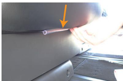
3 カバー前側に付いている固定部材を、生地ごとシートとプラスチックカバーの隙間に入れ込みます。
