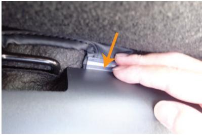
9 取り出した固定部材は、シートとプラスチックカバーの隙間に入れ込み固定します。
