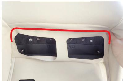
10 パックテーブル固定位置のシート形状に沿うように、カバーの位置を合わせます。
