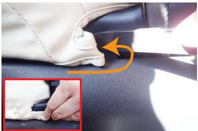
7 カバー内側面のシートベルトバックル付近の生地（赤枠参照）を、ヘラ等を使用し、シートに巻き込むようにしながら、プラスチック部の隙間にに入れ込みます。
