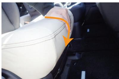
11 シート前側の生地にたるみが出る時は、図のように、カバーをシートに馴染ませるようにしながら、ベルトの締め具合を調整して下さい。
