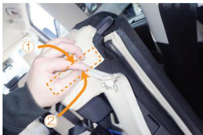
9 ①内側面の生地と、②底面の生地をシートを包み込むようにかぶせ、マジックテープで固定します。
