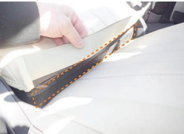
9 シートを後ろに倒した状態で、カバーの端に付いているマジックテープを、シートに直接貼り付け固定します。
