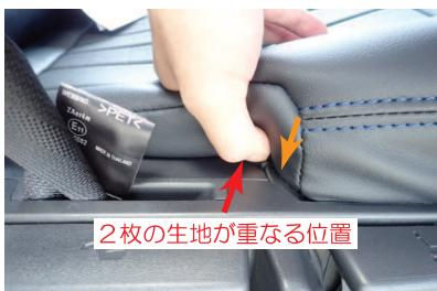
6 次に、上側の生地を下側の生地に重ねるようにしてプラスチックカバーの隙間に入れ込みます。
