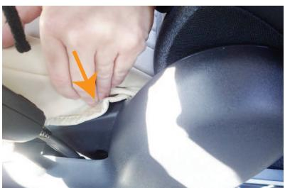
8 シートの付け根部分の隙間に、生地を入れ込みます。
