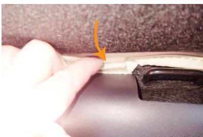
**8** 取り出した固定部材は、シートとプラスチックカバーの隙間に入れ込み固定します。
