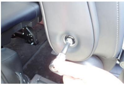
2 ソケットレンチ（14mm）を使用して、ボルトを外すと、アームレストが取り外せます。
