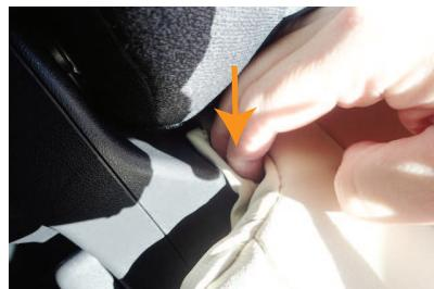
5 シートの付け根部分の隙間に、生地を入れ込みます。
