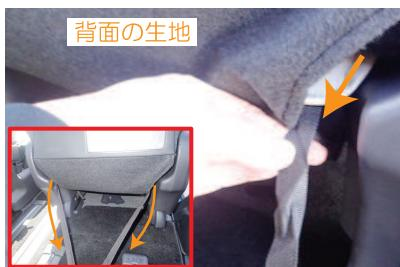
3 入れ込んだ生地を、背面を覆っている生地をめくり隙間から引き出し、生地に付いているベルトを取り出します。（赤枠参照）
