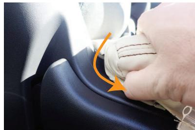
4 シート外側面のコーナー部分に生地を引っ掛けるようにしてカバーをかぶせます。
