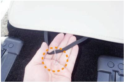
**13** カバー背面の先端には、ゴムが付いています。図のように、付属の金属フックをゴムに取り付けます。
