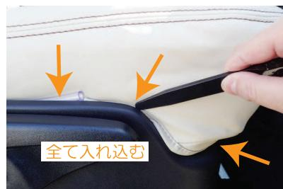
6 シート外側面のプラスチックカバーとシートの隙間に、カバーに付いている固定部材を生地ごと入れ込みます。
