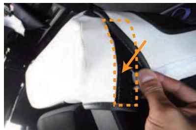
4 カバー内側面の後ろ側のマジックテープと背面から引き出した生地に付いているマジックテープを固定します。
