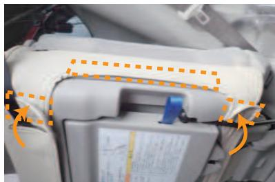
6 カバー座面裏側の生地端に付いているマジックテープと、引き出した生地に付いているマジックテープを固定します。
