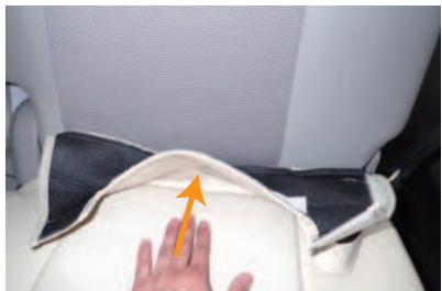
3 背もたれと座面の隙間に生地を入れ込み、入れ込んだ生地を背面から引き出します。
