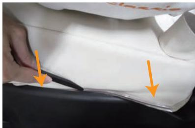
6 助手席側の側面に付いている固定部材を、シートとプラスチックカバーの隙間に入れ込みます。
