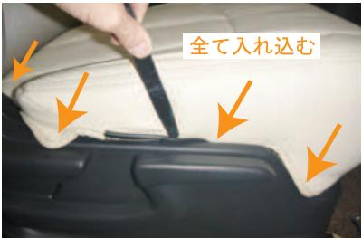
7 シート両側面のプラスチックカバーとシートの隙間に、カバー両側面に付いている固定部材を生地ごと入れ込みます。この時点ですべての生地を、全て隙間に入れ込んで下さい。
