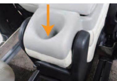
**15** カップホルダー周辺を下に押し込むことでツメが受け側に引っ掛かり、プラスチックカバーが固定されます。
