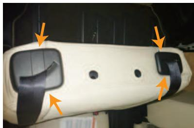
5 2箇所のシートベルトの台座とシートの隙間に生地を入れ込みます。
