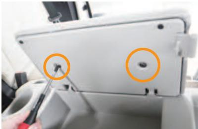
1 フタの裏側のプラスチックカバーを外します。ドライバーを使用し、2箇所のネジを外すことで、プラスチックカバーが外れます。
