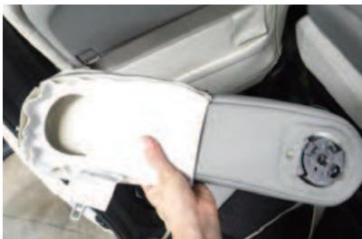
1 カバーの加工穴がアームレストの内側にくるよう、カバーを半分程度裏返し、アームレストのラインに合うようにカバーをかぶせます。
