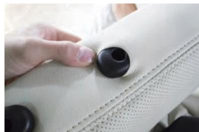
5 カバーの加工穴から生地の伸びを利用してヘッドレストの台座を取り出します。
