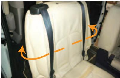
1 カバー背面の2箇所のファスナーを開け、シートベルトの内側を通して、シート全体にカバーをかぶせます。
