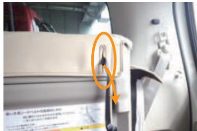
5 シートを跳ね上げ、カバー裏の加工穴からベルトを取り出します。
