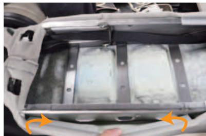
10 純正のシート表皮を固定しているプラスチックフックを取り外し、内側に巻き込んでおきます。
