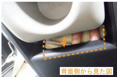
5 3番で引き出した生地に付いている固定部材を、シートとプラスチックカバーの隙間に入れ込みます。ヘラ等を使用して、奥の方まで生地を入れ込んで下さい。
