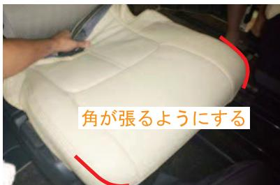
3 コーナー部分がフィットするように、カバーを後ろに引き下げます。
