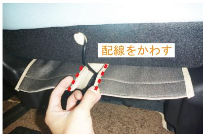
8 入れ込んだ生地を背面から引き出します。座面の時と同様に、配線をかわすようにして下さい。
