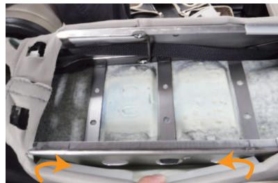
10 純正のシート表皮を固定しているプラスチックフックを外し、内側に巻き込んでおきます。
