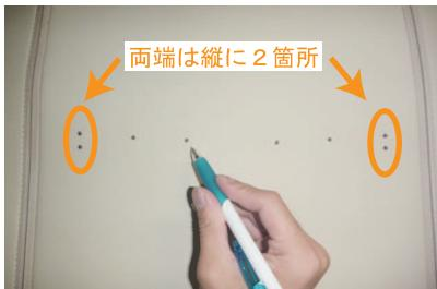
13 テーブル固定用ボルトがある箇所に、ペン等でカバーに印を付けます。（両端は金属がある箇所と、テーブル側にもツメがありますので、その箇所も印を付けます）
