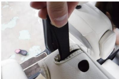
7 カバー上部の加工穴から、リクライニング用ベルトを取り出します。
