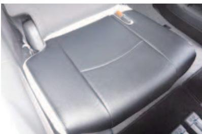
12 カバーのラインを整えて、3列目運転席側座面の完成です。助手席側も同様に取り付けます。
