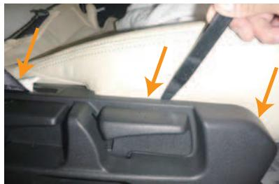
4 カバー両側面の固定部材を、生地ごとシートとプラスチックカバーの隙間に入れ込みます。同時に固定部材が付いていない箇所の生地も隙間に入れ込んで下さい。
