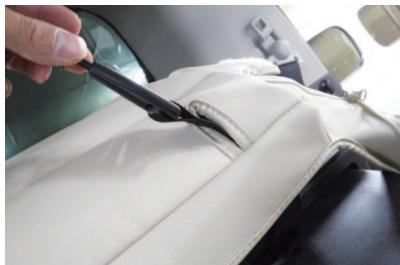
4 シート裏面内側に付いているベルトを、カバーの加工穴から取り出します。
