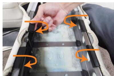
11 カバー両側面に付いているプラスチックフックを、純正のプラスチックフックが固定されていた箇所に取り付けます。
