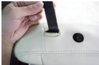
2 シート上側に付いているベルトを、カバーの加工穴から取り出します。
