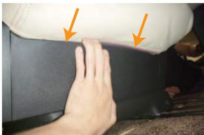
2 カバー前側に付いている固定部材を、生地ごとシートとプラスチックカバーの隙間に入れ込みます。
