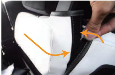
7 カバー内側面の後ろ側のマジックテープと背面の内側にあるマジックテープを固定します。
