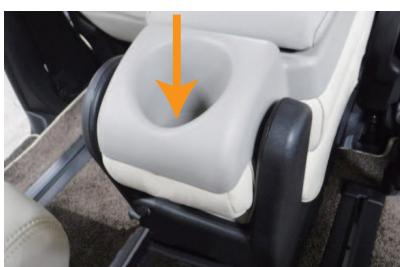
15 カップホルダー周辺を下に押し込むことでツメが受け側に引っ掛かり、プラスチックカバーが固定されます。
