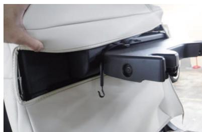
3 シートを跳ね上げて、カバー裏の穴で座面の脚をかわします。
