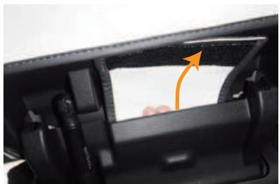
9 シートを跳ね上げ、22ページの1番で入れ込んだ生地を、シート裏面内側の付け根部分の隙間から引き出します。
