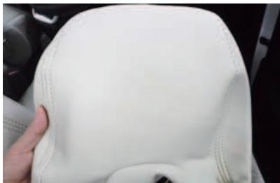
1 かぶせる前にカバーの前後を確認します。ステッチ、もしくはバイピングの入っている方が前です。
