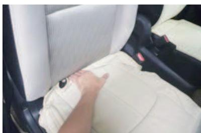
3 背もたれと座面の隙間に生地を入れ込みます。背もたれの角度を調節して、入れ込みやすい角度で行って下さい。
