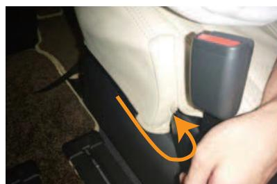
6 カバー内側面の後ろ側の生地を、ヘラ等を使用し、シートを巻き込むように入れ込みます。
