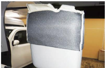
1 幅の狭いマジックテープが付いている方が軸側になるように、カバーを半分程度裏返し、ヘッドレストのラインに合わせてカバーをかぶせます。
