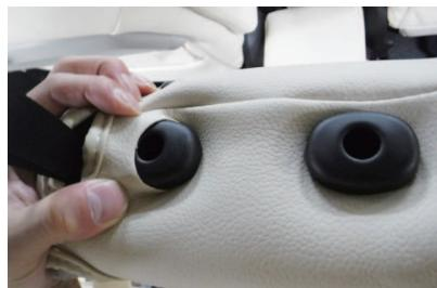
8 カバーの加工穴から生地の伸びを利用してヘッドレストの台座を取り出します。
