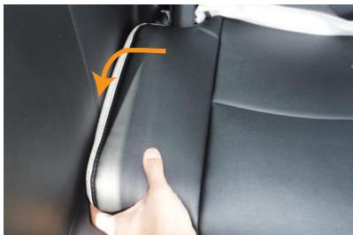
1 外側面の隙間にマジックテープの付いた生地を入れ込み、シートの外側にカバーをかぶせます。
