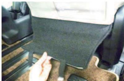
1 始めに、シート背面下の生地が座面裏の金属部分にゴムとプラスチックフックで固定されている為、固定を外します。
