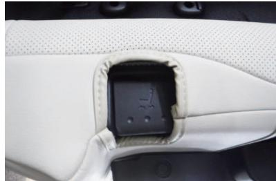
10 シートの前側と後ろ側にあるレバー位置とカバーの加工穴の位置が合っている事を確認して下さい。位置が合っていない場合は位置を合わせるようカバーをシートに馴染ませて下さい。
