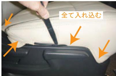
7 シート両側面のプラスチックカバーとシートの隙間に、カバー両側面に付いている固定部材を生地ごと入れ込みます。この時点で両側面の生地を、全て隙間に入れ込んで下さい。
