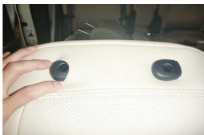
9 カバーの加工穴から生地の伸びを利用してヘッドレストの台座を取り出します。
