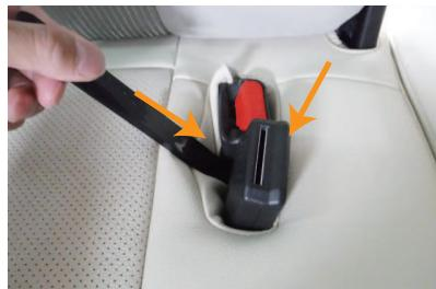
11 シートベルトバックル部分の生地を、ヘラ等を使用し、シートとバックルの隙間に入れ込みます。
