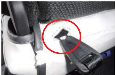
8 カバー背面の加工穴と、シートのベルト収納用穴の位置が合っている事を確認して下さい。ずれている場合はカバーを馴染ませて位置を合わせて下さい。
