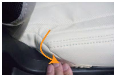
5 シート外側面のコーナー部分に生地を引っ掛けるようにしてカバーをかぶせます。
