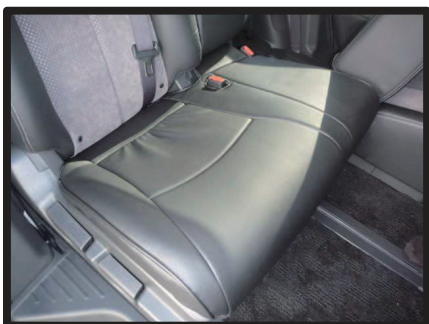
⑲カバーのラインを整え、2列目運転席側座面の完成です。 助手席側は一部形状が異なりますが同様に取り付け、最後に次の図⑳～㉑を参照します。
