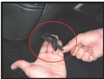
⑰ カバー前部に付いているベルトを後ろ側へ引き出し、図⑬で引き出した生地についているバックルを使い、ベルトを固定します。固定方法は、— 1 1 — 1 5 ページの図④を参照します。
