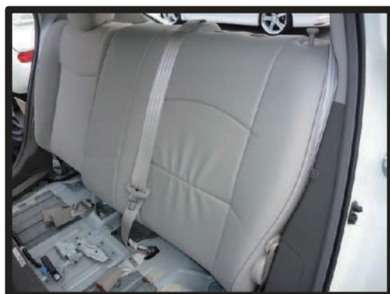
⑱カバーのラインを整え、2列目助手席側背もたれの完成です。運転席側も一部形状が異なりますが同様に取り付けます。
