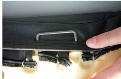
11 シート中央の付け根部分にあるフックを、 カバーの加工穴に通します。
