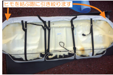
10 ベルト、ヒモを固定した写真です。 ヒモを結ぶ際に引き絞ります
