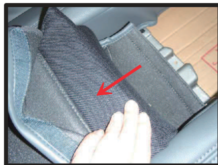
⑫アームレストの表側に出ている生地を、アームレストとカバーの間に入れ込んで下さい。
