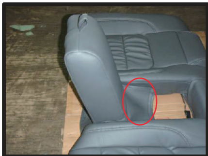
⑪アームレストにカバーをかぶせます。カバーの前後は図の丸印内の生地が背もたれ側にくるように取り付けます。
