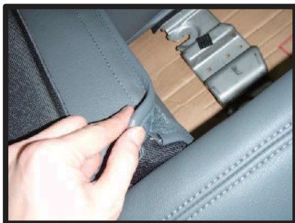
⑬アームレスト下側のマジックテープ同士を取り付けて固定します。
