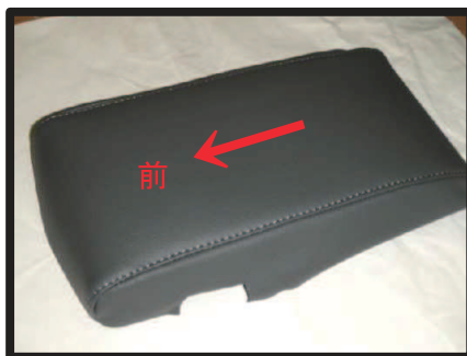
⑪ カバーの前後を確認して上ブタにかぶせます。 内側に巻き込む生地は両面テープ等で固定します。
