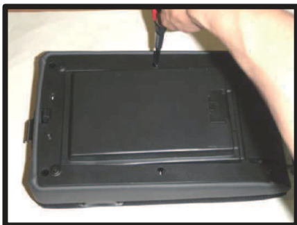
⑦ 枠をコンソールボックスに戻し、ネジで固定します。
