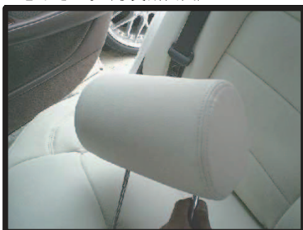
⑥カバーのラインを整え、完成です。 ※後期型(0527)の2列目ヘッドレストは左右で形状が異なりますので、カバーの左右に注意して取り付けて下さい。
