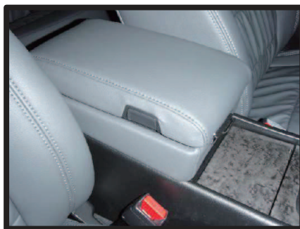
⑫ 上ブタを元に戻し、コンソールボックスを車体に固定します。 コンソールボックスの完成です。
