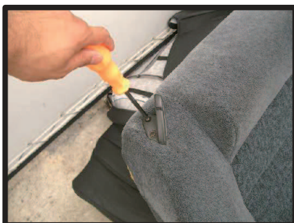
⑤シートベルト受けのプラスチックも取り外します。カバー取付後、同位置に取り付け直します。
