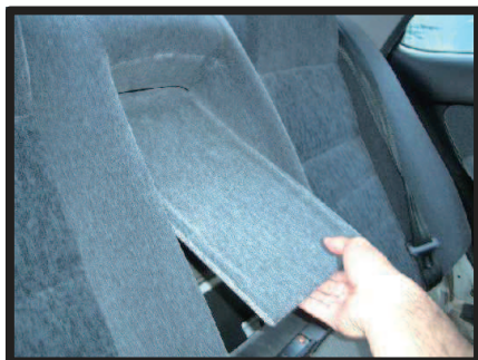
①アームレスト裏側のパネルを取り外します。
