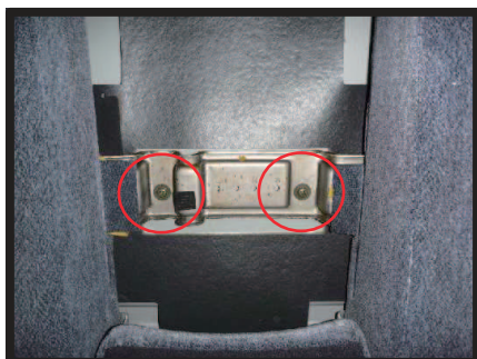
②パネルを取り外すと、ネジが2本隠れていますので、+ドライバーで外します。
