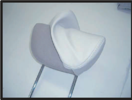
①ヘッドレストの片側から、カバーを被せていきます。
