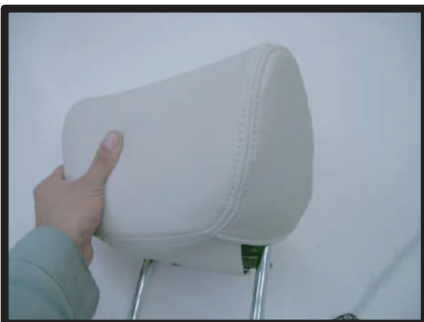
③ヘッドレストのラインに合わせて、生地が馴染むようにカバーを整えていきます。
