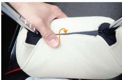
3 ヘッドレストをシートから外し、カバー前面に付いているラバーフックを固定します。詳しい固定方法は4番を参照して下さい。
