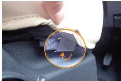
18 外側面のカバーの裏に付いているプラフックを、シートのフチに引っ掛けて固定します。
