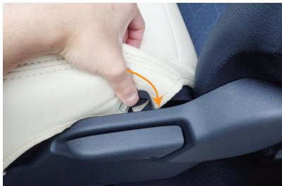
25 カバー外側面の付け根の生地に付いているゴムに、付属の金属フックを取り付け、生地ごと隙間に入れ込みます。
