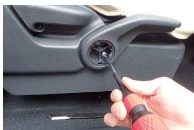
17 フタを外すと2本のネジでレバーが固定されている為、ドライバー等を使用し、固定を外します。
