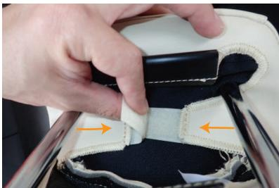
9 ヘッドレストをシートから外し、カバー左右に付いているマジックテープ同士をヘッドレスト裏で固定します。
