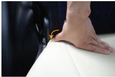
10 シートの根本の生地を、シートとプラスチックカバーの隙間に入れ込みます。
