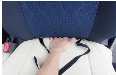
23 背もたれと座面の隙間に生地を入れ込みます。
