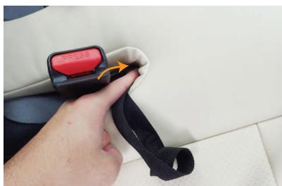
9 カバーのシートベルトバックル収納部分に付いているベルトを隙間に入れ込みます。
