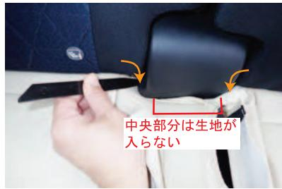
13 ヘラ等を使用し、固定部材が付いている生地をシート中央の軸部分に入れ込み固定します。
