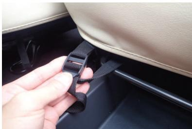
29 前側に通したベルトと、カバー前側に付いているバックルを固定します。
