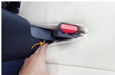
8 カバー内側面の付け根の生地に付いているゴムを、生地ごと隙間に入れ込みます。
