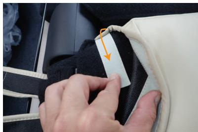
8 背面側に回した生地に付いているマジックテープを、直接シートに貼り付け固定します。
