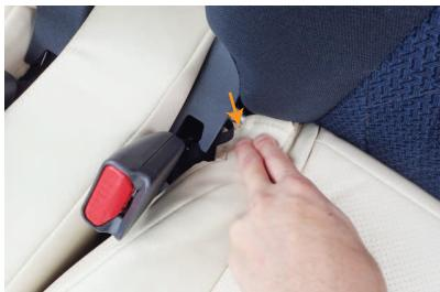
26 カバー内側面の付け根に付いているゴムを生地ごと隙間に入れ込みます。
