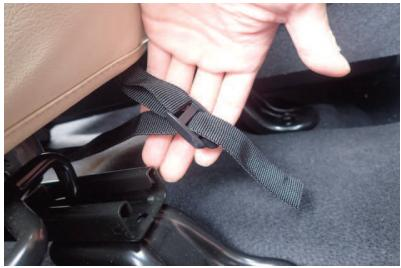
14 13番で引き出したベルトと、カバー前側に付いているバックルを固定します。
