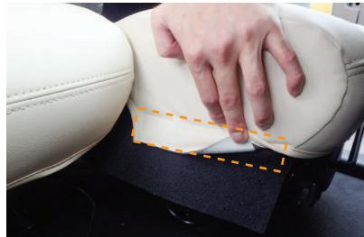
32 内側面の生地裏に付いているマジックテープを純正のシート表皮に直接貼り付け固定します。
