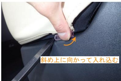
30 カバー外側面に付いている固定部材を、シートとプラスチックカバーの隙間に入れ込み固定します。
