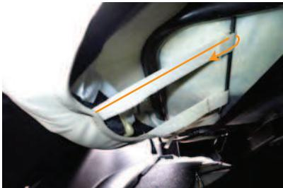
12 カバー両サイドに付いているベルト（片方3本の計6本）をシート裏の金属部分に巻き付けて固定します。
