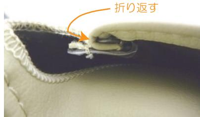
4 フックはカギ状になっているプラスチックに板状のプラスチックを、生地と共に折り返して挟み込み固定します。
