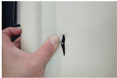
10 シート背面のチャイルドシート固定フックの位置と、カバー背面の加工穴の位置が合っている事を確認して下さい。
