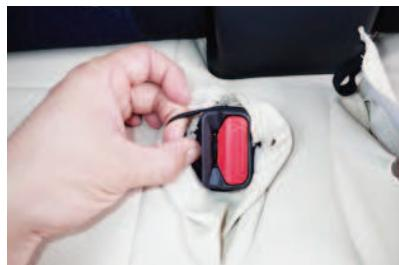
14 シートベルトバックルを加工穴から取り出し、生地に付いている2本のゴムをシートベルトバックルに通します。
