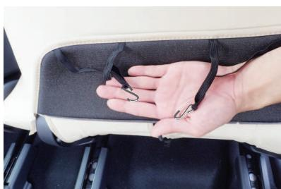
12 カバー背面下部の生地に付いているゴムに付属の金属フックを取り付けます。
