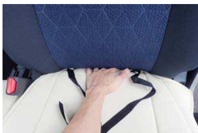
23 背もたれと座面の隙間に生地を入れ込みます。 ※背もたれの角度を調節し、入れ込みやすい角度で行ってください。
