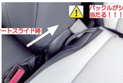
24 シートベルトのバックルが、ベルトから抜き出た状態で使用していると、シートをスライド時に、図のようにバックルがシートに当たり、最悪の場合破損する可能性があります。バックルはしっかりベルトに固定した状態にしておくようにして下さい。
