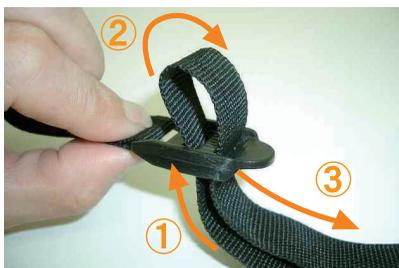
15 ベルトは①→②→③の手順で、まずバックル中央に通し、折り返してバックルの端に通します。通したベルトを引くとカバーの前後を引き絞り固定されます。ベルトは強く引くと縫製糸が切れて、ベルトが抜けてしまう恐れがあるので、注意して下さい。
