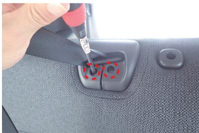
1 中央のシートベルトが出ている箇所のプラスチックパーツを外します。シートベルトを上へ上げるとネジが2本あります。プラスドライバーを使用してネジを外します。
