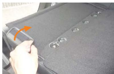
18 カバー両側面の生地に付いているマジックテープをシートに直接貼り付けて固定します。
