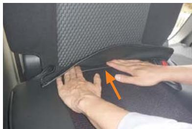
6 背もたれと座面の隙間に生地を入れ込みます。
