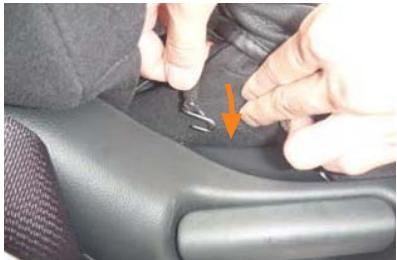
7 シート外側面に付いているゴムに付属の金属フックを取り付け、シートとプラスチック部の隙間に入れ込み、座面裏側から引き出します。
