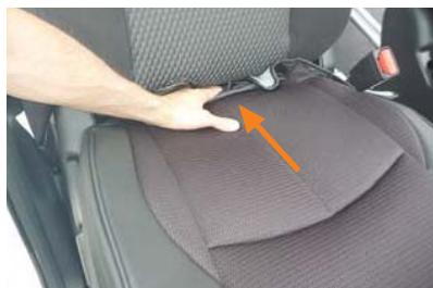
5 背もたれと座面の隙間に生地を入れ込みます。背もたれの角度を調整して入れ込みやすい位置で行って下さい。
