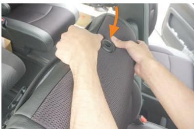
9 ヘッドレストの台座を取り出します。まず台座の片方のフチに生地をしっかりと入れ込みます。
