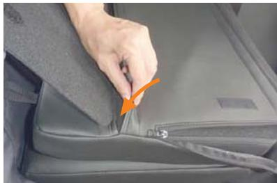
6 ボードの下の生地に付いているマジックテープをシートに直接貼り付けて固定します。
