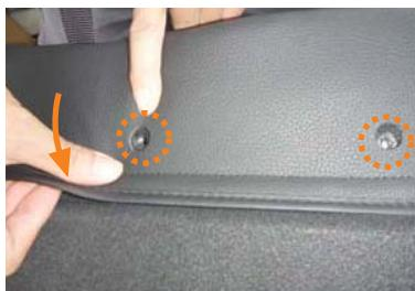
5 背もたれ背面のカバーの加工穴を、ベルトのボルト位置に合わせます。カバーの端に付いているマジックテープをシートに直接貼り付けて固定します。
