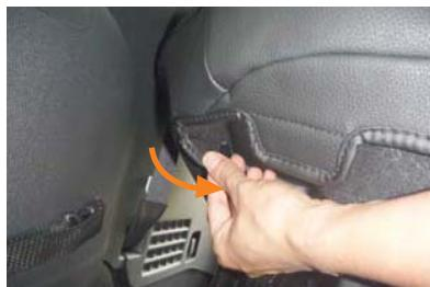
5 マジックテープは座面裏側で図のように固定します。
