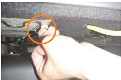
8 引き出したゴムを、座面裏側の金属バーに引っ掛けで固定します。
