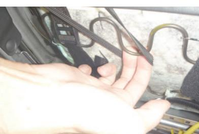
15 カバー背面下に付いているゴムはシート裏側の金属部分に引っ掛けて固定します。
