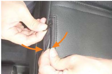
7 カバー内側面のファスナーを、生地を内へ寄せながら閉じます。ファスナーの端はカバーの内側へ入れ込みます。
