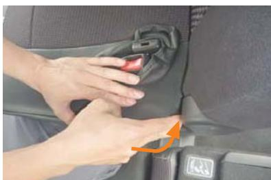
9 カバーの内側面の付け根の生地を、シートを包み込むように入れ込みます。
