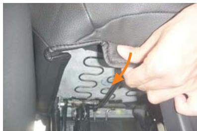
10 座面先端部の下部に付いている魔术贴テープをシートに直接貼り付けて固定します。
