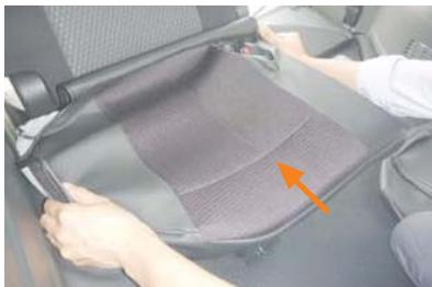
1 シートのラインに合わせて、カバーをシート先端から後方へかぶせます。
