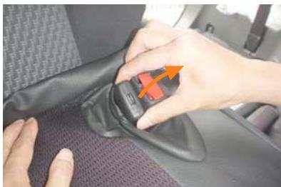
2 カバーの加工穴からシートベルトバックルを取り出します。
