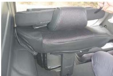
3 カバー外側面の生地に付いているマジックテープを固定させるために、背もたれのリクライニングレバーを引き、シートを浮かせながら作業を行います。
