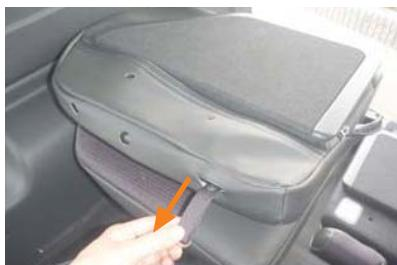
4 カバーをシート全体にかぶせ、リクライニングベルトをカバーの加工穴から取り出します。
