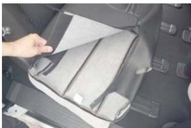
1 始めに1列目同様、左右のアームレストを外し、カバー側面に付いているファスナーを開けます。
