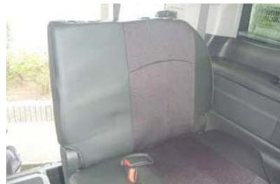
**22** 背面のベルトを元通りに戻します。カバーのラインを整え、3列目助手席側背もたれの完成です。
