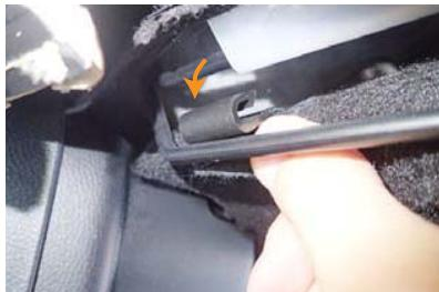
10 純正表皮をめくった箇所に、純正表皮をシートに固定しているプラスチックフック（白色ではなく黒色のフック）がある為、固定を外します。
