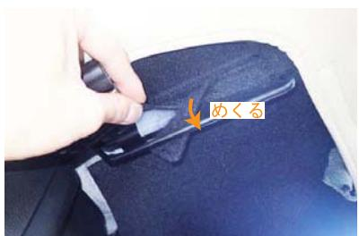
9 マイナーチェンジ後のお車は、シート裏の純正表皮がマジックテープで固定されている為、固定を外します。
