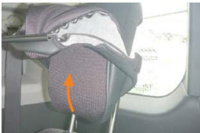
1 3列目ヘッドレストは前側から後ろ側へかぶせていきます。この際ヘッドレストの先端まで生地が張るようにかぶせます。
