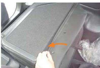
**21** 運転席側背もたれと同様に生地に付いているマジックテープをシートに直接貼り付けて固定します。
