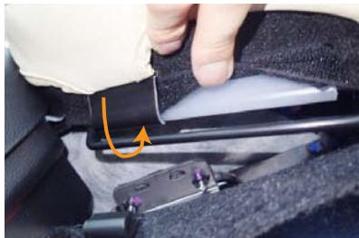
11 カバー裏面に付いているプラスチックフックを純正プラスチックフック（白色）の上から固定します。
