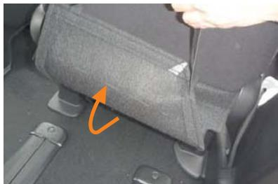
1 始めに、シート後ろ側から底面を覆っている生地を取り外します。生地はシート底面の金属部分に、ゴムで固定されていますので、ゴムを外して下さい。
