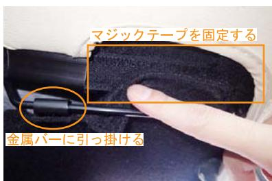
12 10番で外した純正プラスチックフックを金属バーに引っ掛け固定します。また、9番で外したマジックテープを固定します。
