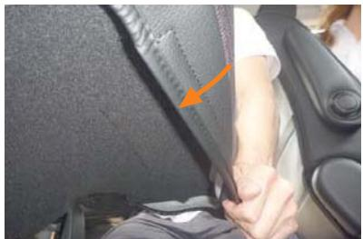
7 カバー先端裏側に付いているマジックテープをシートに直接貼り付けて固定します。
