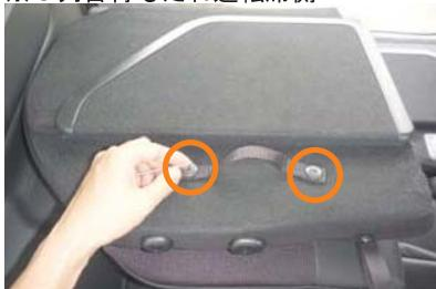
1 始めに、背もたれを倒し背面のベルトを六角レンチ（5mm）を使用し外します。
