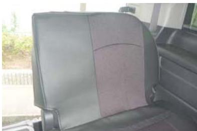
13 始めに、運転席側と同様に背面のベルトを外し、シートのラインに合わせカバーをかぶせます。
