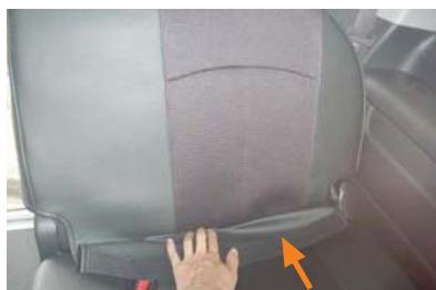
14 背もたれと座面の隙間に生地を入れ込みます。
