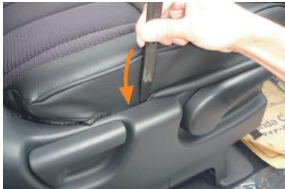
**13** カバー側面の生地を、ヘラ等を使用しシートとプラスチック部の隙間に入れ込みます。
