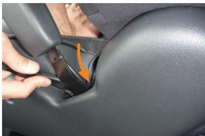
**14** カバー内側面の生地をシートとシートベルトバックルの隙間に入れ込みます。
