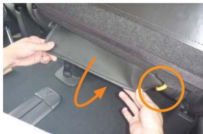
6 入れ込んだ生地をシート背面から引き出します。シートと配線の間にカバーを入れ込み、引き出した生地でシートを巻き込むようにします。
