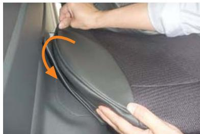
4 カバー外側面に付いているマジックテープを生地に直接貼り付け固定します。
