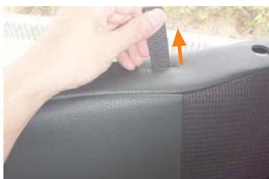
15 リクライニングベルトをカバーの加工穴から取り出します。
