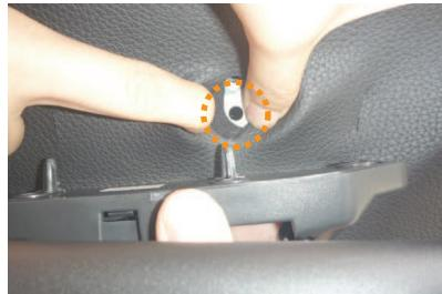
16 シートバックテーブルを戻す際は、まず中央部分の穴に、バックテーブルの突起部分を入れ込み、位置決めをしてボルトを戻していきます。
