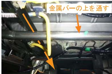
10 ベルトはシート裏側にある金属バーや配線の上を通し、干渉しないようにして、シート背面からベルトを引き出します。
