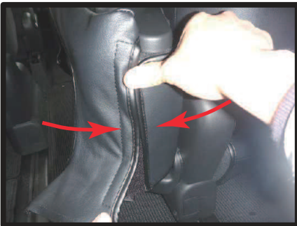
⑤ 補助席を跳ね上げ、座面の後ろ側で生地同士をマジックテープで固定します。
