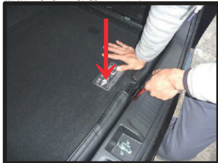
④床下格納後のロック部分は、カバーの厚みでシートが浮いてきますので図のようにシートを押しえながらロックを掛けます。
