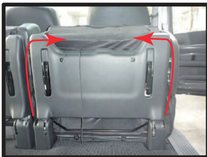
⑩カバー両側面のヒモを矢印のように座面下を沿わせ、後ろ側に持ってきます。
