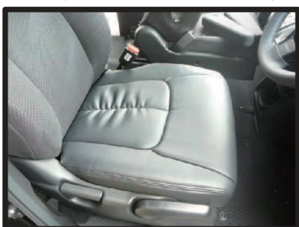
⑫カバーのラインを整え、1列目座面の完成です。助手席側も同様に取り付けます。
