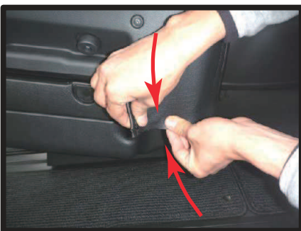
⑥ 内側面の生地と、底面の生地も同様にマジックテープで固定します。
