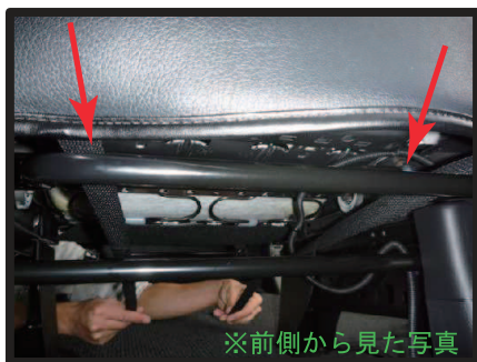
⑨カバー前側に付いているベルトを、図のように座面下から、後ろ側へ通します。この際、ベルトは座面下の金属バーの上側を通すようにします。
