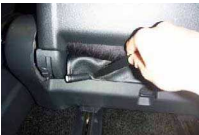
9 入れ込んだ生地をシート背面から引き出して、ヘラを使用してシートの隙間に生地を入れ込みます。
