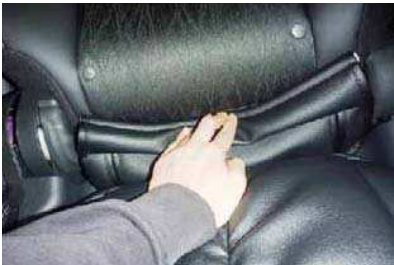
8 背もたれと座面の隙間に生地を入れ込みます。
