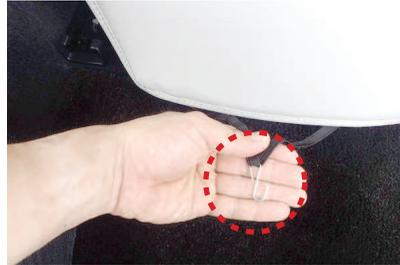
10 カバーの背面下側に図のようなゴムが付いています。ゴムに付属の金属フックを取り付けて、シートの裏に引っ掛けて固定します。金属フックの固定は特定の位置はありません。フックにある程度のテンションが掛かる位置で固定して下さい。
