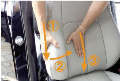
8 ①～③の順番に、カバー側面の生地を引き下げながら中央へ寄せて、中央で余った生地を下へ撫で下ろします。シートの下に余った生地を5番と同様にシート裏から引き出して、生地をシートに密着させていきます。カバー側面のシワが無くなるまで繰り返し行って下さい。
