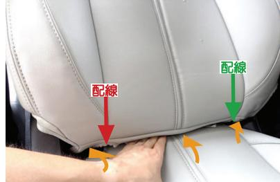
4 背もたれと座面の隙間に生地を入れ込みます。
