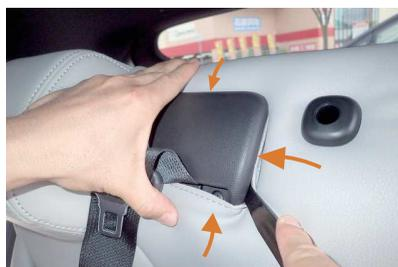
11 プラスチックパーツのフチにヘラなどを使用して生地を入れ込みます。生地を全て入れ込めたら、緩めていたネジを締め直します。
