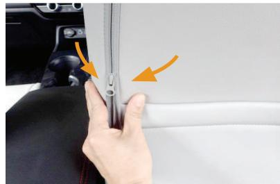
6 カバー背面の両端に付いているファスナーを、生地を内へ寄せながら慎重に閉じます。ファスナーを閉じる際、ペンチなどの工具を使用して無理やり閉じようとすると、ファスナーが破損する恐れがあります。
