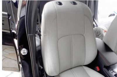
11 サイドエアバッグの展開部分とシートカバーのSAB対応の縫い目部分が合っていることを確認して下さい。カバーのラインを整えて、1列目運転席（パワーシート）の完成です。助手席も同様に取り付けます。
