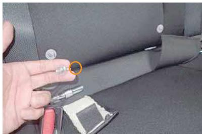
2 助手席側の背もたれと座面の隙間に奥にあるボルトで、シートを固定しています。
