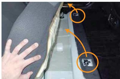
3 座面裏側にあるレバーを引きながら、シートを持ち上げるように外します。
