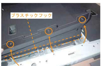
18 助手席側の背もたれも、運転席同様に背もたれ背面のボードと、シート生地を固定しているプラスチックフックを外しておきます。
