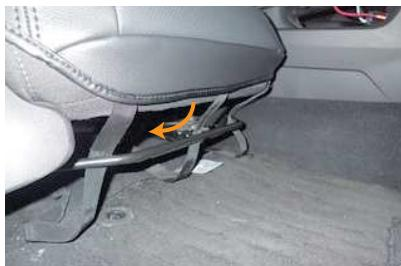
5 カバー前側に付いているベルトを、スライドレバーや配線に干渉しないように、シート裏側から背面へ通し、4番で引き出した生地に付いているバックルで固定します。
