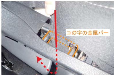
10 金属フックを取り付けたゴムを、シートとプラスチックカバーの隙間にあるコの字の金属バーの間を通して、シート底面から引き出します。
