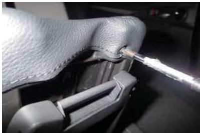
**20** カバーにネジが通るくらいの小さい穴を開けて、ネジを戻します。この際、締めすぎないように注意して下さい。強く締めすぎるとカバーが裂ける恐れがあります。
