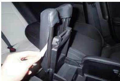
18 13番で貼った両面テープをはがし、コンソールに直接貼り付けて固定します。コンソールの樹脂の部分にカバーの裾を合わせるように貼り付けます。
