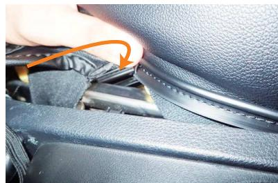
8 カバー外側面のリクライニングレバー付近に付いているプラスチックフックを、シート本体を内側に押し付けると見える金属部分に引っ掛けで固定します。
