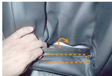
**29** アームレスト収納部の奥を整えて（プラスチックパーツを外した際にフック等が元の位置からずれてしまう為）、カバーのマジックテープ部分を、シートに直接貼り付けます。
