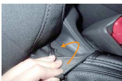
11 内側面シートベルトバックル付近のカバーを、シートのプラスチック部の隙間に入れ込みます。
