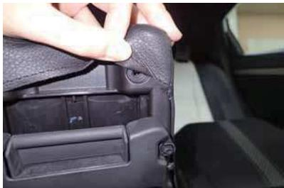
**19** カバーの隙間から、ネジ穴の位置を確認します。
