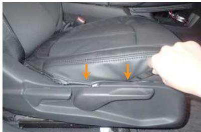
7 カバー外側面の生地に付いている固定具をシートのプラスチック部の隙間に入れ込みます。
