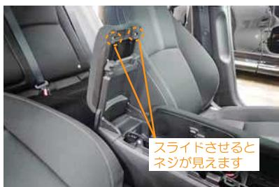
14 コンソール部分に付いているネジをプラスドライバー等で外します。（2ヵ所）
