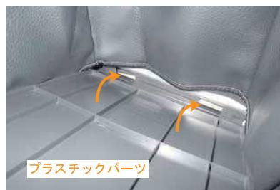
**30** **26番**で外したプラスチックパーツを元に戻します。アームレスト収納部奥の下側から取り付けます。
