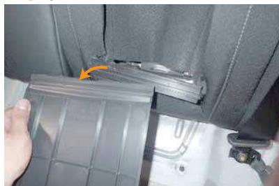
**26** 下部はプラスチック同士で固定されていますので、横にスライドさせると取り外します。
