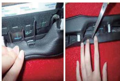
**10** 図のように小さなツメもカバーの切り込みで、かわして貼り付けて下さい。又、生地が入り込まない部分があれば、ハサミ等で切り込みを入れて下さい。
