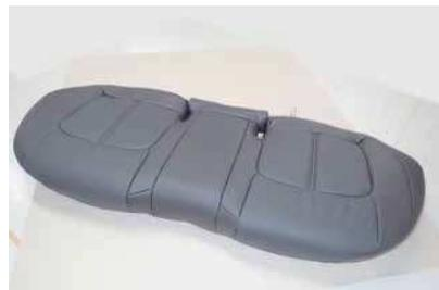
**12** カバーのラインを整え、2列目座面の完成です。座面は2列目背もたれの装着後、車体に戻します。
