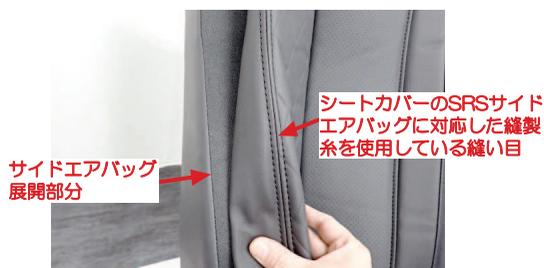
3 サイドエアバッグの展開部分と、シートカバーのSRSサイドエアバッグに対応した縫製系を使用している縫い目の位置（以降SAB対応の縫い目部分）を合わせます。※シートのサイドエアバッグ展開部分にはシートカバーの縫い目が必ず存在します。その縫い目はSRSサイドエアバッグに対応した縫製系を使用しています。
