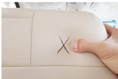
16 運転席と同様にカバーを取り付けます。コンビニフックを取り外して穴が開いている部分を指で確認しながら、カバーに印を付けます。
