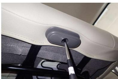
9 13ページ1番で外したプラスチックパーツを、生地を挟み込むようにして戻します。
