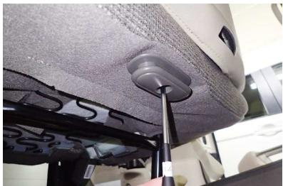
1 始めに、シート裏のプラスチックパーツをドライバーを使用して外します。
