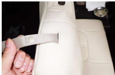
6 シート肩口のリクライニング用のストラップをカバーの加工穴から取り出します。
