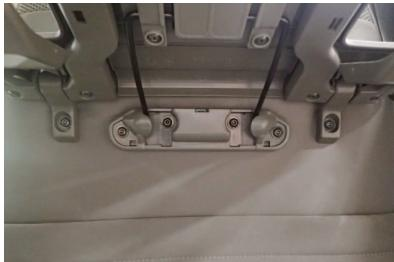
2 テーブルを持ち上げると、テーブルの下側にボルトが見えます。（計6ヶ所）
