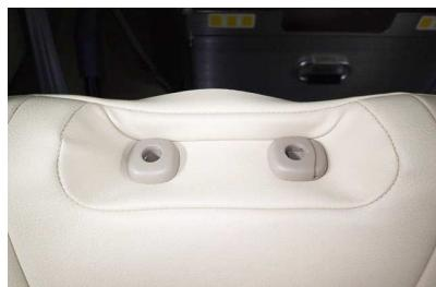
11 カバーの加工穴からヘッドレストの台座を取り出します。
