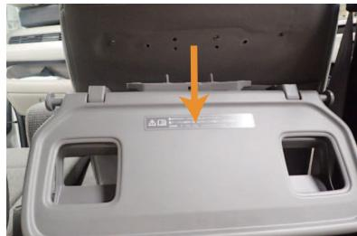
4 ボルトを外し、テーブルを手前に引くようにするとシートからテーブルが外せます。
