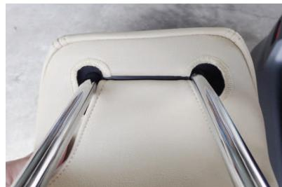
10 ヘッドラストをシートから外し、ヘッドラスト裏で、1列目と同様にプラスチックパーツでカバーを固定します。
