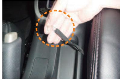
**10** カバー内側面に付いているゴムに、付属のS字フックを取り付けます。
