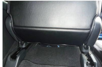
**11** シート底面の金属部に、付属の金属フックを引っ掛け固定します。
