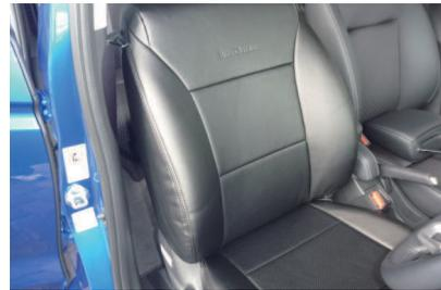
**12** サイドエアバッグ装備車は、サイドエアバッグの展開部分とシートカバーのSAB対応の縫い目部分が合っていることを確認して下さい。
