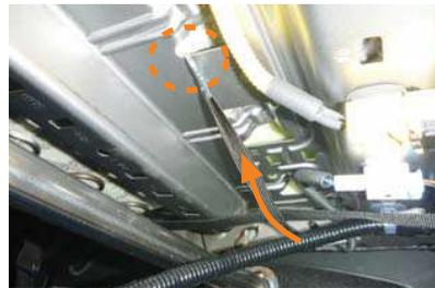
**11** シート底面の金属部に、S字フックを引っ掛け固定します。
