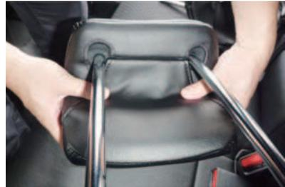
**10** ヘッドレストをシートから外し、ヘッドレスト裏で、1列目と同様にブラフックでカバーを固定します。
