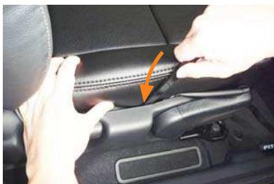
**5** 外側面の生地をシートとプラスチック部の隙間に入れ込みます。
