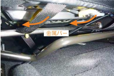
**7** カバー前側に付いているベルトを、図のように金属バーの上側を通して、後ろ側へ引き出します。
