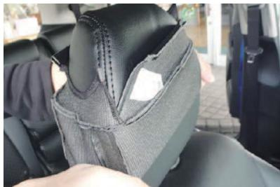
1 カバーを裏返してヘッドラストのラインに合わせてかぶせます。この際ヘッドラストの先端まで生地が張るように、しっかりとかぶせて下さい。
