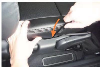
5 外側面の生地をシートのプラスチック部の隙間に入れ込みます。
