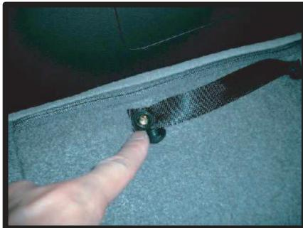
①背もたれカバーをかぶせる前に背面のベルトを外しておきます。プラスチックのカバーを取り、ネジを外します。
