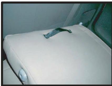
③マジックテープを固定します。ベルトのネジ穴の位置に小さく穴を開け、ベルトを元通りに取り付けます。
