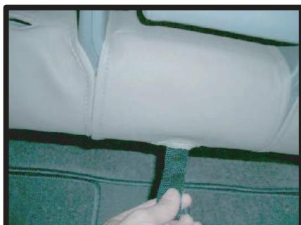
③座面後ろの中央部分にベルトがありますので、位置を合わせてマジックテープを固定します。
