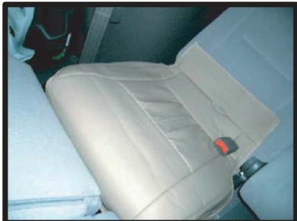
①座面カバーをかぶせます。前からもぐり込ますように入れ込み、シートベルトを穴に通します。
