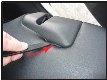
㉑ 図のプラスチックパーツ部の隙間にヘラ等を使用し、生地を入れ込みます。
