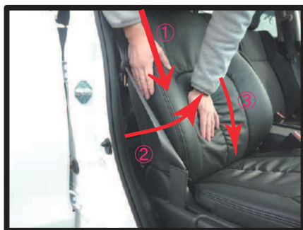
⑪図の①～③の順番に生地をなで下ろしてシートに密着させるようにしわを無くして行きます。
