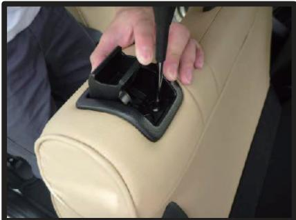
⑯7ページ②で外したレバー部分を、外した逆の手順で元に戻します。
