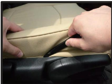
③側面の生地をシートのプラスチック部の隙間に入れ込みます。
