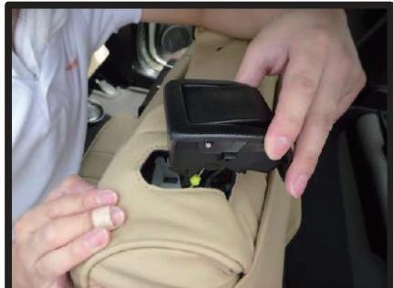
④カバーの加工穴から②で外したレバーパー部分を取り出します。
