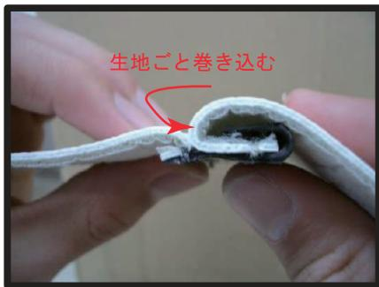
②ヘッドレストを取り外し、プラフックで固定します。図のように、平らな形状の方を、生地ごと巻き込みながら、カギ状の方に差し込み、固定します。
