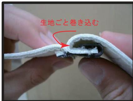
④アームレストカバーは、プラフックで固定します。図のように、平らな形状の方を、生地ごと巻き込みながら、カギ状の方に差し込み、固定します。
