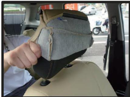
①カバーの前後を確認し、半分ほど裏返した状態でヘッドレストにかぶせます。カバーを左右均等に引き下げていきます。
