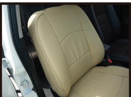
⑫サイドエアバッグ装備車は、サイドエアバッグの展開部分とシートカバーのSAB対応の縫い目部分が合っていることを確認して下さい。
