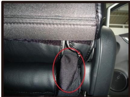
⑨引き出した生地は、背もたれ後ろ側の生地とマジックテープで固定します。この際、シートヒーター やサイドエアバッグ装備車の場合は、図のように配線をかわして下さい。
