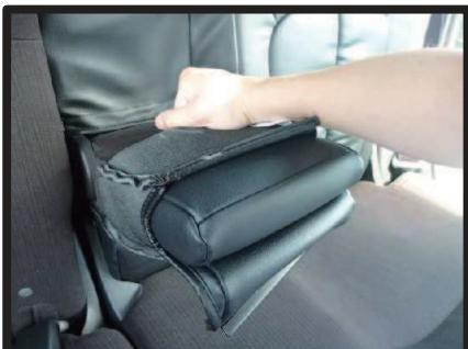
①カバーの前後を確認し、アームレストにかぶせます。カギ状のプラスチック部品が付いている方が、前側になります。カバーは先端までしっかりと入れ込んで下さい。
