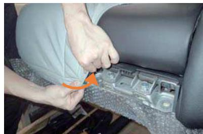
11 シートの中央までカバーをかぶせたら、図のシートのフチに生地を引っ掛けるようにかぶせます。
