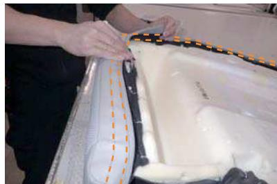
23 シート裏側の側面から前にかけて、マジックテープを直接シートに貼り付けて固定します。図の点線部分がマジックテープが付いている位置になります。
