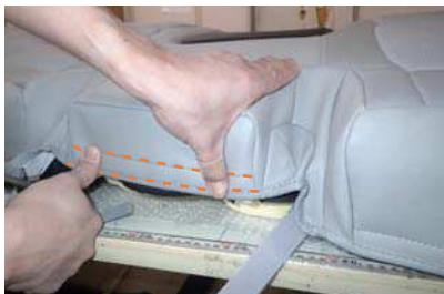
19 シート中央の後ろも、マジックテープを直接シートに貼り付けて固定します。
