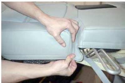
20 シートベルトバックルが収まるシートのフチに、生地を馴染ませるように整えます。
