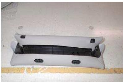
2 片方の角に引っ掛けた部分を軸にして、もう片方の角にもカバーを引っ掛けます。 パーツ全体にカバーをかぶせて、ラインを整えます。
