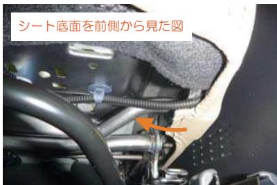
8 カバー内側面に付いているゴムに、付属の金属フックを取り付け、シート底面の金属部に引っ掛け固定します。
