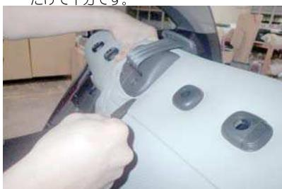
18 プラスチックパーツのフチに、ヘラなどを使用して生地を入れ込みます。生地をきれいに入れ込めたらネジを締め直します。
