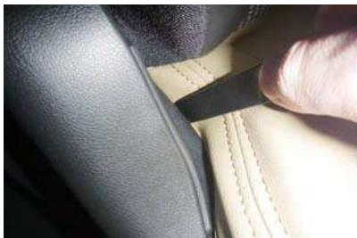
7 背もたれと座面の付け根付近（5番の矢印部）の隙間に生地を入れ込みます。
