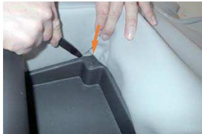
16 シートを表側に戻し、反転テーブルを出してマジックテープが端に付いていた生地をトレーとシートの隙間に入れ込みます。へうなどを使用してシートの形状に沿わせて生地を入れ込みます。
