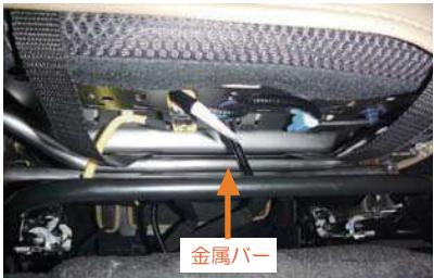
9 カバー前側に付いているベルトを、シート底面を通して、後ろ側から引き出します。この際、ベルトは図の金属バーの上側を通して下さい。
