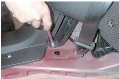
2 サイドシートは下側で車体とボルトで固定されています。ソケットレンチなどを使用してボルトを外します。
