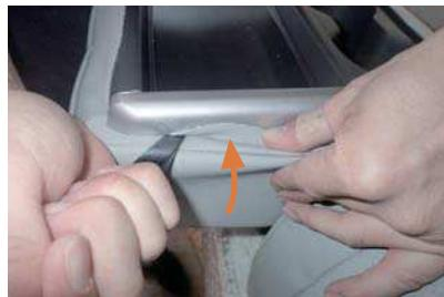
7 ドリンクホルダーのあるボックス部分のフチに生地を入れ込みます。プラスチック部分に傷を付けないように慎重に作業を行って下さい。
