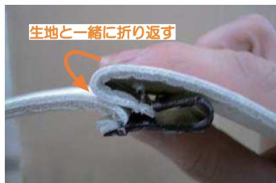
6 プラフックの固定方法は、カギ状のフックに平らな方のプラスチックを生地と一緒に折り返して、はめ込み固定します。
