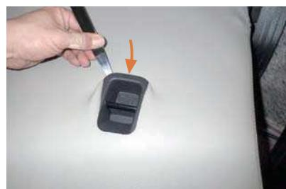
21 シート背面のチャイルドシート固定用アンカー部分に、ヘラなどを使用して生地を入れ込みます。
