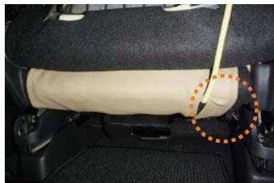
11 4番で引き出した生地（図の○部）に付いているゴムに、付属の金属フックを取り付け、シート底面の金属部に引っ掛け固定します。
