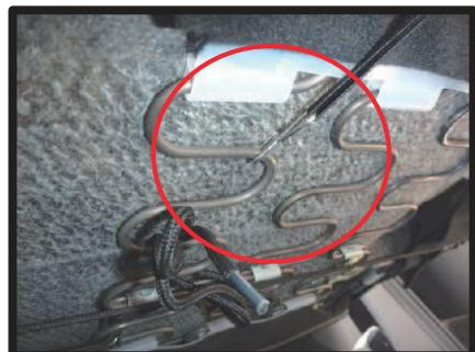
⑫シートカバー前方に2本、内側側面に1本あるゴムに付属のS字フックを取り付けます。S字フックは座面裏の金属部分に引っ掛け固定します。
