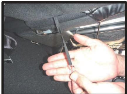
⑪⑤で入れ込んだ生地に付いているゴムをシート裏から取り出します。S字フックを取り付けシート裏の金属部分に引っ掛け固定します。
