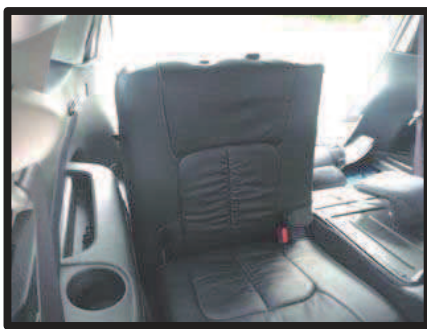
⑫カバーのラインを整え3列目運転席側背もたれの完成です。助手席側も同様に取付けます。
