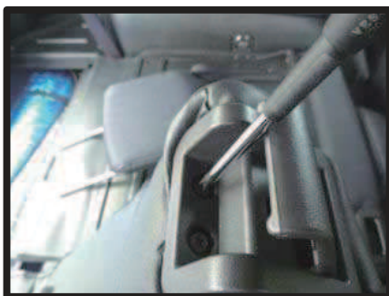
⑪リクライニングレバーのネジをドライバー等で緩め、カバーをシートとプラスチックの隙間に入れ込みます。
