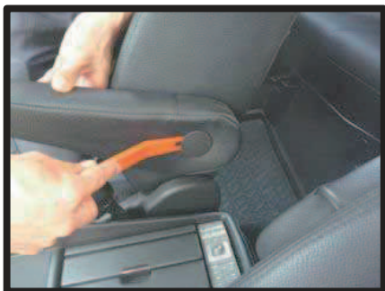
①ヘラ等を使用し、アームレストのキャップを外します。
