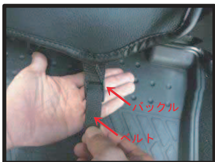
⑨4ページ⑤で引き出した生地についているバックルと⑧で引き出したベルトを固定します。
