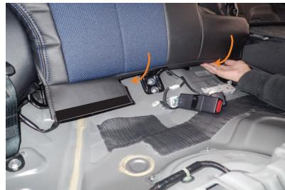
16 シートの隙間にカバー下部の生地を入れ込みます。配線をカバーの切れ込みで交わしながら、背面へ生地を回して下さい。
