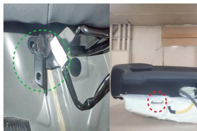
5 シートは図の○部分にフックがはまる形で固定されています。○部分はドア側のチャイルドシート固定アンカーの付近にあります。以上を踏まえて4番の工程を行って下さい。
