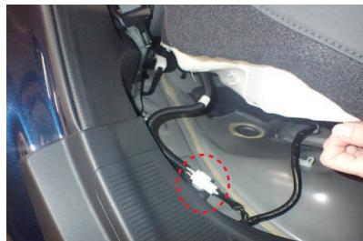
6 シート本体と車体を繋いでいる配線を取り外します。図は運転席側（2列目）の外側です。○部分の凸を押しながら、はめ込まっている方のカブラーを引くと固定が外れます。この際、線を引っ張らないように注意しながら取り外して下さい。
