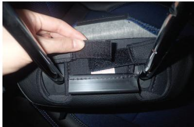
4 ヘッドレストの底面のマジックテープを留め合わせて固定します。
