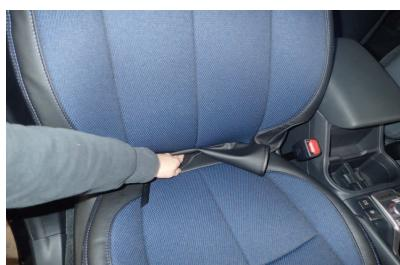
7P ▶ 3 座面と背もたれの隙間に生地を入れ込みます。背もたれの角度を調節して、入れ込みやすい角度で行って下さい。
