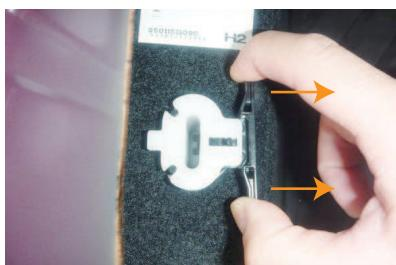
2 レバーは図のようになっており、矢印の方向へレバーを引くことでシートの固定を外せます。
