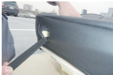
10 8番で通したベルトをカバーの大きい方の加工穴に通します。小さい方の加工穴にはシートヒーターの配線を通します。
