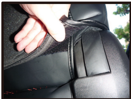
⑧4ページ④で引き出した生地と背面 の生地をマジックテープで固定しま す。
