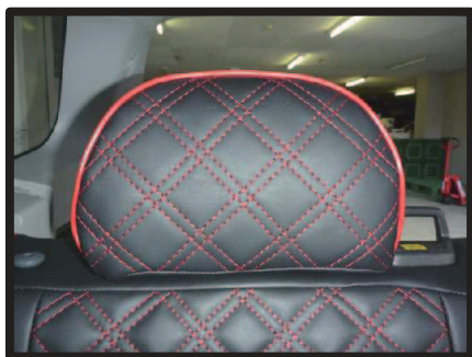
⑨ ヘッドレストを台座に戻し、カバーのラインを整え、2列目両端のヘッドレストの完成です。
