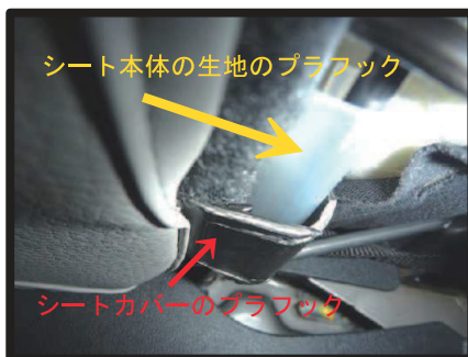
③シート本体の生地を固定しているプラフックの上から、カバーのプラフックを引っ掛けて固定します。
