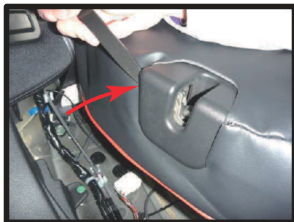
⑭シート外側面のヒンジのあるプラスチックパーツの隙間に、ヘラ等を使用し、生地を入れ込みます。
