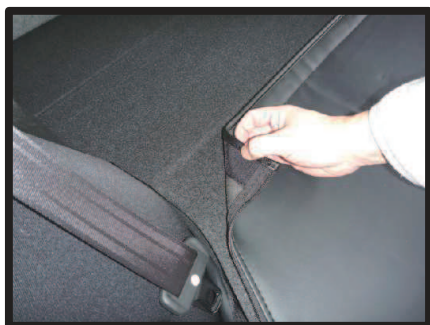
⑮カバー背面の生地は、マジックテープで直接シート背面に固定します。
