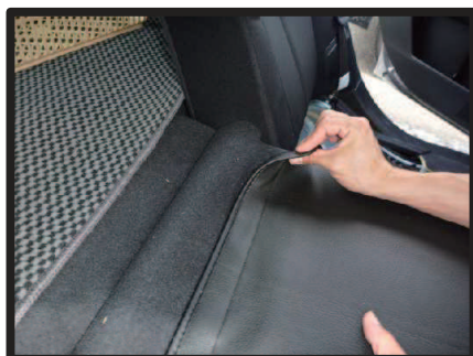
⑪カバー背面の生地を、シートにマジックテープで直接固定し、7ページ①で外した生地を元に戻します。
