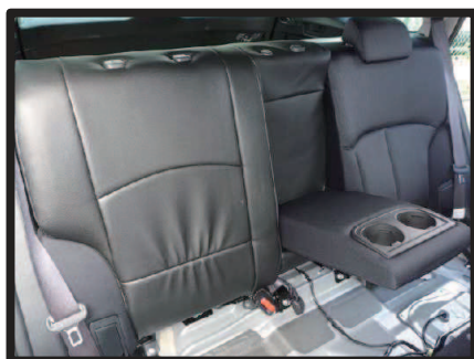
⑫カバーのラインを整え、2列目背もたれの完成です。助手席側も一部形状が違いますが、同様に取り付けます。
