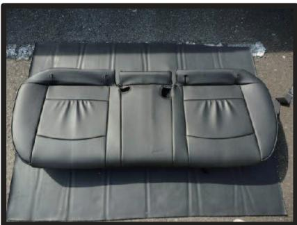
⑫カバーのラインを整え、2列目座面の完成です。シートは背もたれカバー装着後に元に戻します。
