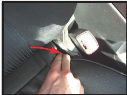
⑩図のように、シート内側の生地をシートの隙間に入れ込みます。
