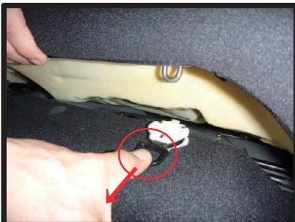
②金具は図のように、手前に引っ張る事でロックが外れますので、ロックを外しながらシートを浮かせるようにする事で金具が外れます。
