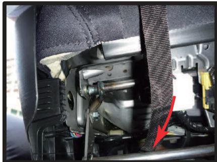
⑦カバー前部に付いているベルトをシートの下側を通し、後ろ側から引き出します。シートの動作に干渉しないよう、図のように金属パーツをかわすようにして下さい。
