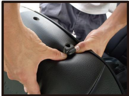
④ヘッドレストの台座部分をカバーの加工穴から取り出します。生地の伸びを利用して横から潜り込ませるよう取り出します。
