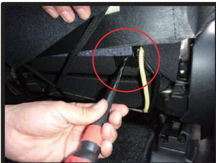
②生地をめくり上げると、図のようにバックボードを固定するネジがありますので、+ドライバーを使用しネジを外します。（左右2ヶ所）
