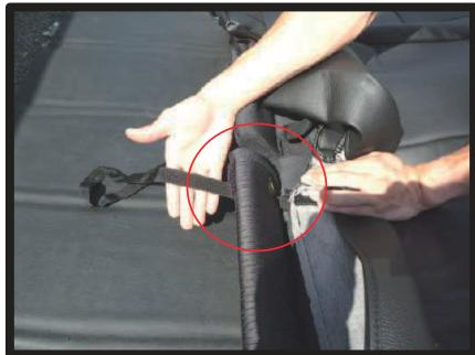
⑦5ページ⑥で通したベルトは、図のようにシートの後ろ側へ引き出します。
