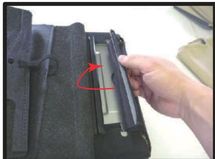
②生地はフックに引っ掛けるように固定されていますので、図の矢印方向にめくり上げるようにすると外れます。
