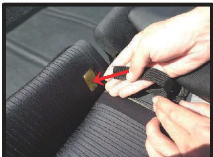
⑥シートのチャイルドシート固定用フック部に付いている生地を外し、図のようにカバーに付いているベルトを通します。
