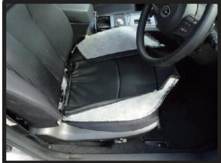
④カバーを図のように裏返した状態でシートのラインに合わせます。
