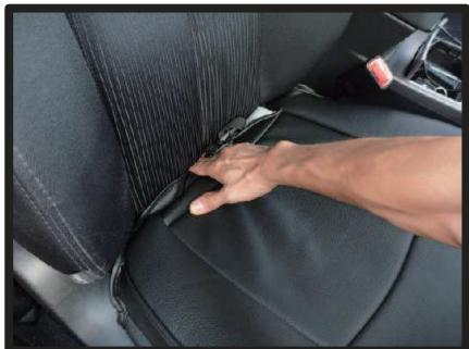
⑥背もたれと座面の隙間に生地を入れ込み、後ろ側から引き出します。
