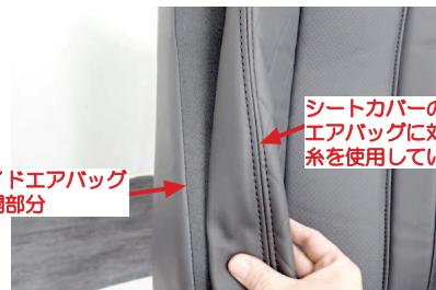
3 サイドエアバッグの展開部分と、シートカバーのSRSサイドエアバッグに対応した縫製糸を使用している縫い目の位置（以降SAB対応の縫い目部分）を合わせます。
