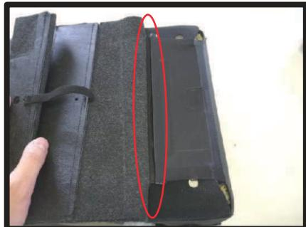
①7ページ⑥で外したアームレストを裏返し、図の○部分で固定されている生地を外します。
