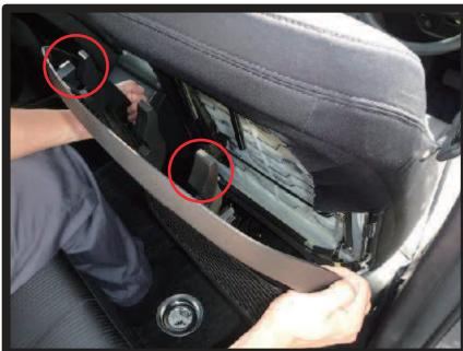
③ネジを外し、バックボードを押しながら引き下げるようにすると、背もたれに固定されているツメ（図の赤丸部）が外れ、バックボードが取り外せます。
