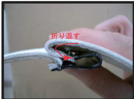
⑬ プラフックの固定方法は、カギ状のフック部に、平らなプラスチック部を、生地ごと巻き込み固定します。
