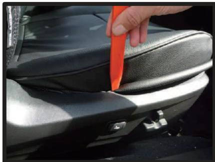
⑧外側側面の生地をヘラ等を使用し、シートとプラスチック部の隙間にに入れ込みます。
