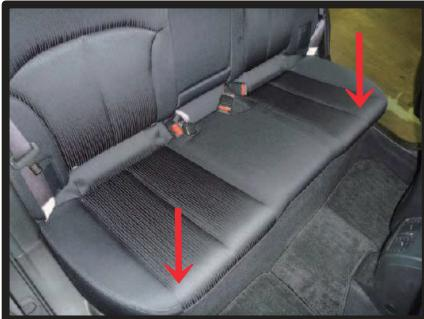
①始めてに車体からシートを取り外します。シートは図の矢印の位置に金具で固定されています。
