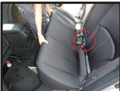
③金具を外すと、図のようにシートを手前に持ち上げる事が出来ますが、図の○位置に、もう1ヶ所金具で固定されています。
