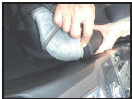
⑨カバーの内側側面には、マジックテープが付いていますので、シートの側面の生地に直接固定します。
