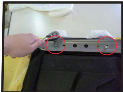
⑥背もたれを裏返し、アームレストを固定しているナットを、ラチエット等を使用し外します。
