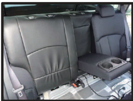
⑫カバーのラインを整え、2列目背もたれの完成です。助手席側も一部形状が違いますが、同様に取り付けます。
