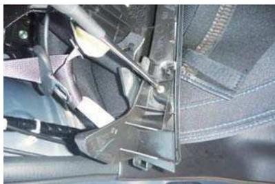
7 パーツ裏側のネジをプラスドライバーで外します。（計5箇所）
