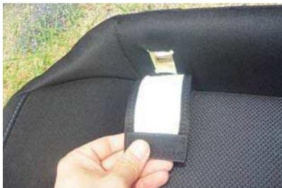
7 シートのチャイルドシート固定用加工穴を隠している生地のマジックテープを外します。(計4箇所)
