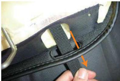
10 8番で通したベルトをシートの背面から引き出して、カバーの加工穴に通します。
