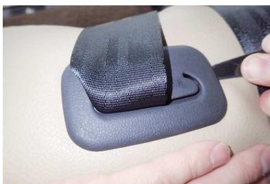
**11** ヘラ等を使用し、シートベルト付け根のプラスチックパーツとシートの隙間に生地を入れ込みます。
