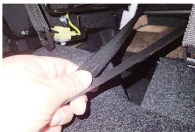
**16** ベルトをシートの前側から取り出し、カバーの前側に付いているバックルと固定します。
