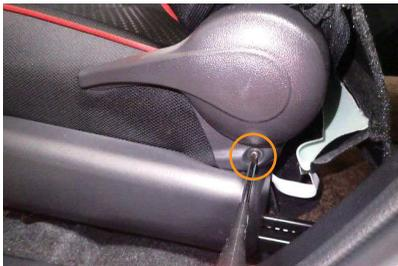
**7** リクライニングレバー下部のネジをドライバを使用して外します。
