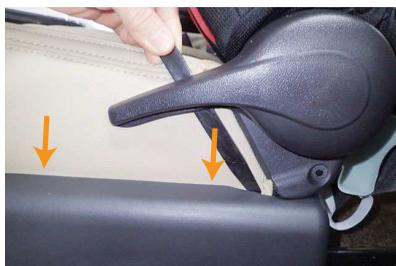
**12** カバー外側に付いている固定部材をシートとプラスチックカバーの隙間に生地ごと入れ込みます。
