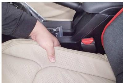
**14** カバー内側面の生地裏に付いているマジックテープをシート表皮に直接貼り付けて固定します。
