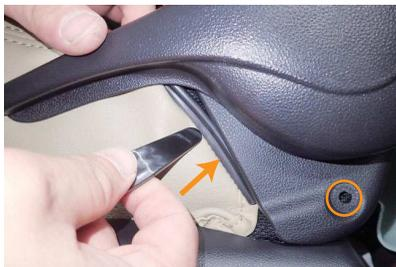
**11** ヘラ等を使用し、リクライニングレバー下部のプラスチックカバーとシートの隙間にカバー外側面の根本に付いている固定部材を入れ込みます。入れ込んだ後、7番で外したネジを元に戻します。
